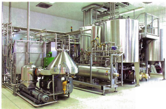
IN DIESEN KESSELN erfolgt die Uperisation des Presssaftes, damit das Produkt jahrelang lagerfähig ist.
